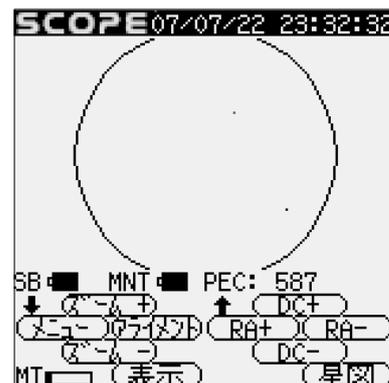
しばらくガイド星を観察していると追尾方向(赤経方向)にズレが生じ始めることがありますので、このズレを感知した時点で、ずれた分だけ「RA+」「RA-」キーで修正を行います。
