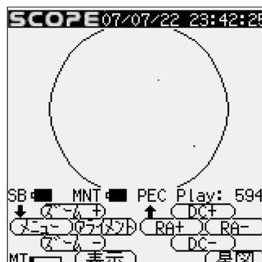
再生を中止するには、PEC制御画面にて再生中止を選択します。
