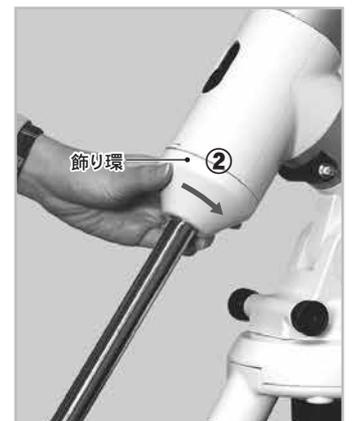
**18** ウェイト脱落防止ネジを回して取外します。
