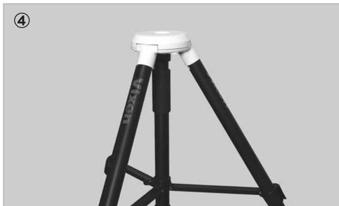
**6** 水平支点(ツノ)を取付けます。水平支点は、ガイドパイプの下にねじ込まれていますので、これを取外し、三脚架台上面にあるネジ穴にねじ込みます。ゆるまないようにしっかりと固定してください。※
