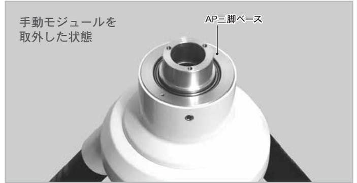
5 赤経モーターモジュールを取付けます。写真を参考に電気接点のある面を外側(上側)に向けて赤経モーターモジュールをはめこみます。
