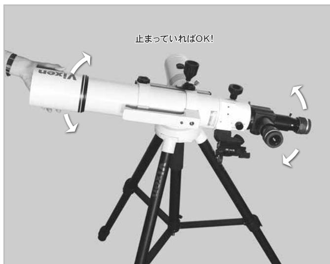
4 どちらかに偏っている場合は、2.を参考に鏡筒の位置を移動して様子を見てください。最終的に偏りが感じなくなった時点で調整完了です。調整後は鏡筒固定ネジ、鏡筒落下防止ネジをゆるまないようにしっかりしめてください。
