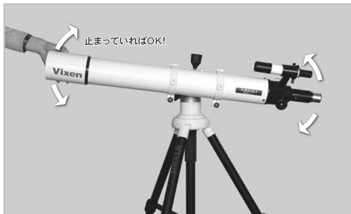
3 どちらかに偏っている場合は、1を参考に鏡筒の位置を移動して様子を見てください。最終的に惰性の偏りが感じなくなった時点で調整完了です。調整後は鏡筒バンドしめネジをしっかり締めてください。
