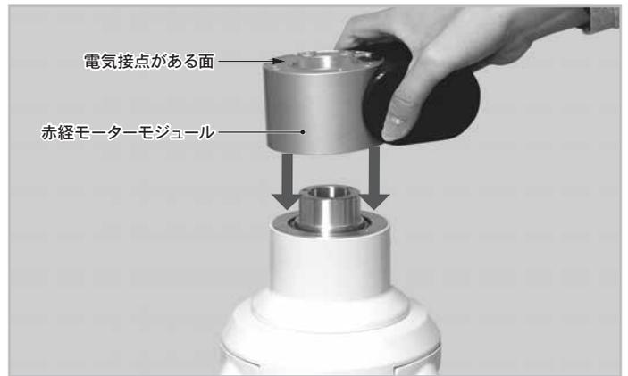
6 写真を参考に赤経モーターモジュールを回して、ネジを通す穴(ネジ切りのない大きいほうの穴)の位置を合わせた後、手動モジュールを取外した際のネジ3本をねじ込みます。
