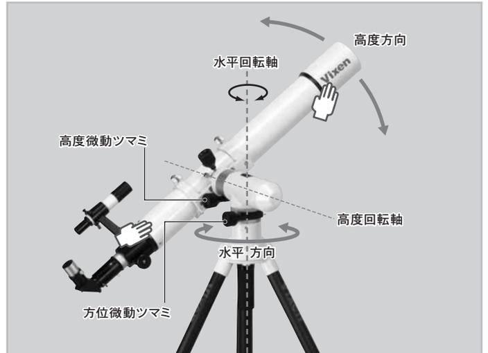
2 微動ツマミを回すことで、それぞれ高度方向、方位方向に微動動作できます。
