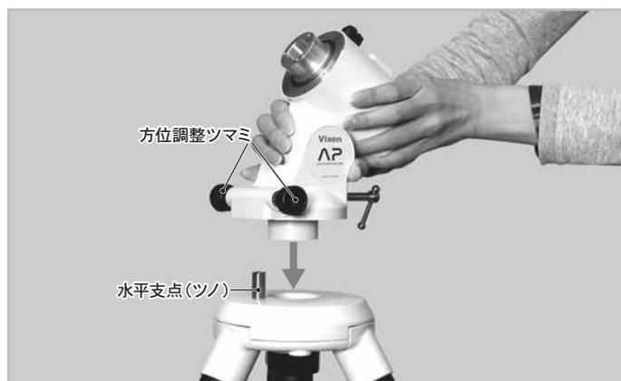
9 AP極軸体ユニットが落下しないように手で押さえ①、もう片方の手でガイドパイプを持ち上げながら②、(上から見て)反時計まわりに回します。ネジがねじ込まれますので、AP極軸体ユニットを持ち上げても固定される状態になるまでしめます。
