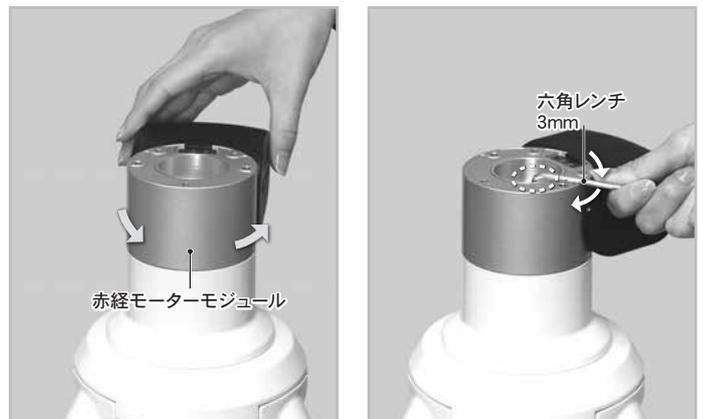
7 赤緯体の電気接点と赤経モーターモジュールの電気接点を合わせて赤緯体をはめ込みます。接点を傷めないようにご注意ください。
