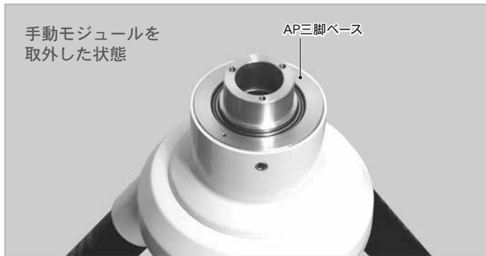
**5** AP三脚ベースを三脚から取外します。ステアロックネジをゆるめ①、ステアを持ち上げると②、ガイドパイプが回せるようになります③。ガイドパイプをゆるめるとAP三脚ベースが取外せません④。ガイドパイプをゆるめる際、AP三脚ベースと一緒に回らないように手で押さえながら作業してください。
