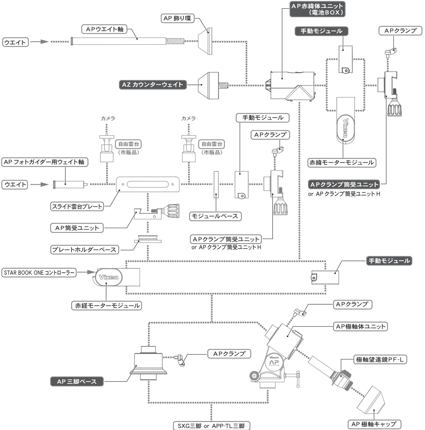
AP赤緯体、赤経モーターモジュール、赤緯モーターモジュールは内部接点を装備しており、接続すると相互通電します。STAR BOOK ONEコントローラーを赤経モーターモジュールに接続して制御します。
