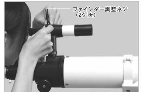
3 ファインダーをのぞきながら天体望遠鏡本体でとらえた目標物がファインダーの十字線中央に重なるように2本のファインダー調整ネジを出し入れして調整します。
