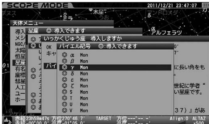
5 自動導入する場合は方向キー(▲・▼)で恒星を選択し、(ENTER)キーを押します。
