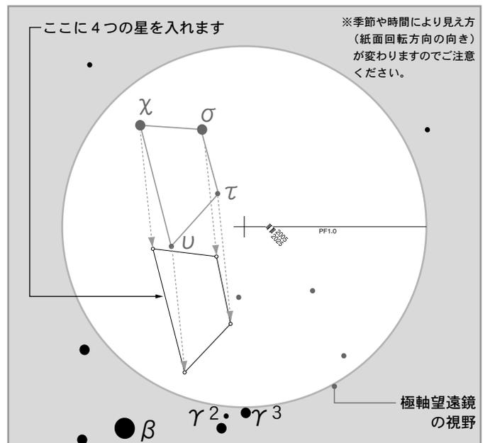
**7** 極軸望遠鏡をのぞきながら、方位調整ツマミと高度調整ツマミを回して図のようなスケールの所定位置に八分儀座4星が収まるように調整します。
