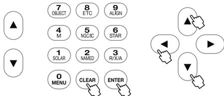
方向キー **▲**・**▼** で設定する項目を選択し、**ENTER** キーを押します。その後設定を完了する場合は **CLEAR** を押します。(または方向キー **◀** を2回押します。)
