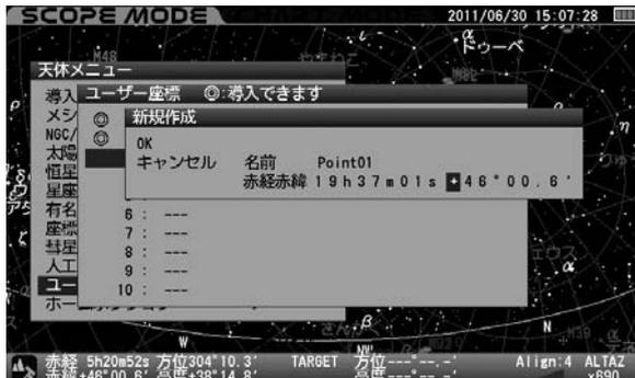
方向キー(◀)・(▶)で設定値までカーソルを移動し、ヒント44 方向キー(▲)・(▼)または10キー(テンキー)にて文字または数値を入力します。すべて入力完了後(ENTER)を2回押して入力完了です。
