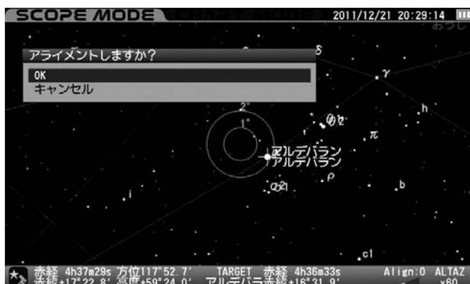
確認のメッセージが表示されますので方向キー (▲・▼) でOKを選択し、「ENTER」キーを押します。
