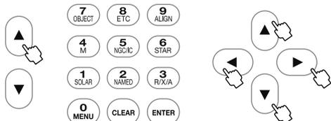
※画面の拡大率は方向キー(▲・▼・◀・▶)を操作していた時のモータースピードに連動します。
