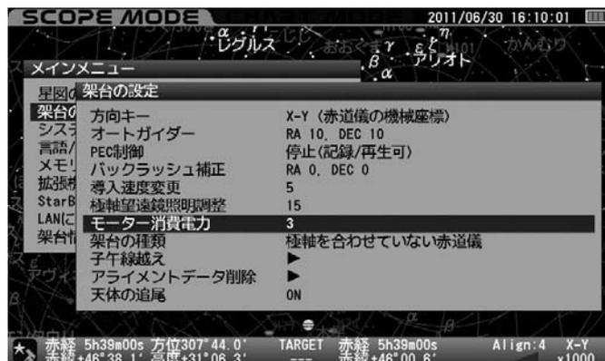
2 “モーター消費電力”画面が表示されます。方向キー ▲・▼ で“1~4”を選択し、**ENTER** を押します。
