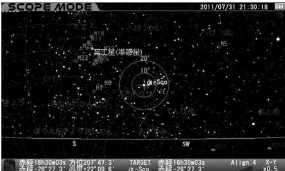
しばらくガイド星を観察していると追尾方向(赤経方向)にズレが生じ始めます。このズレを感知した時点でズレた分だけ方向キー(◀・▶)で修正します。
