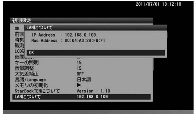
LAN接続されていない場合はIPアドレスのところに”Disconnected”、接続作業中の場合は”Waiting...”と表示されます。
