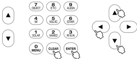
方向キー(▲)・(▼)でON/OFFを選択し、(ENTER)キーを押します。その後設定を完了する場合は(CLEAR)を押します。(または方向キー(◀)を2回押します。)
