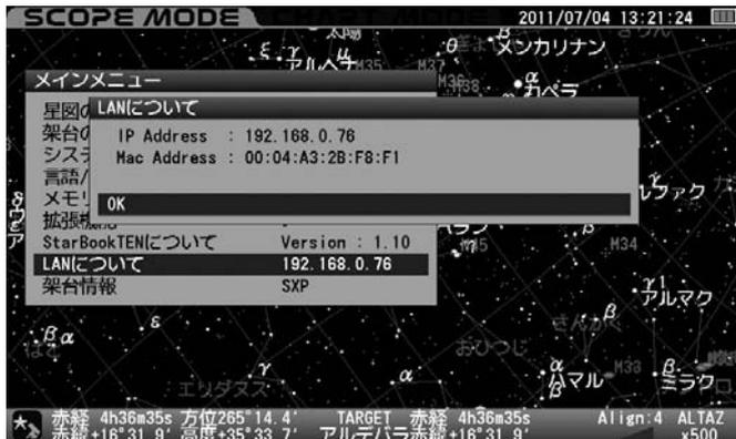
LAN接続されていない場合はIPアドレスのところに“Disconnected”、接続作業中の場合は“Waiting....”と表示されます。
