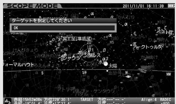
■ アライメントを取得した時点における高度方位データをもとに個々のアライメントデータを認識しています。このため日周運動により約10度以上移動している場合(例えば天の赤道付近の天体であれば時間で約40分以上経過している場合)、同じ天体をアライメントに使用した場合でも別のデータとして認識されます。
