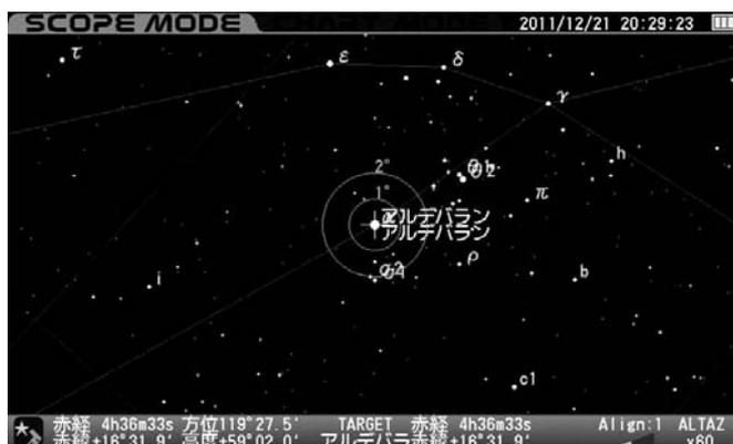
これで1点アライメントの設定が完了したことになります。液晶モニター画面上では目標天体“アルデバラン”と視野円の中心が一致します。
