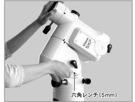
**7** 高度調整クランプを再度ゆるめ、使用する地域の緯度に合う位置まで高度調整ツマミで動かします。
