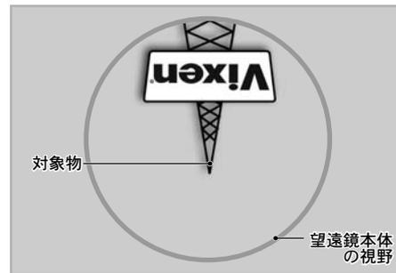
**2** 天体望遠鏡本体に低倍率となる接眼レンズを取付け、“まず天体望遠鏡をのぞいてみましょう”項目(P25参照)に従い遠距離にある目標物(鉄塔の先端など)を、天体望遠鏡本体をのぞきながら視野にとらえます。
