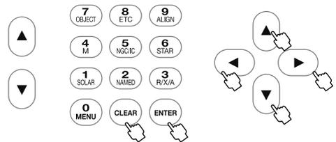
3 (ENTER) または方向キー (▶) を押すとNGC224が選択され“NGC224 導入しますか?”というメッセージが表示されます。 **ヒント39** 導入する場合は (ENTER) 、導入する天体を変更する場合は方向キー (▲)・(▼) でキャンセルを選択し、(ENTER) または方向キー (◀) にて前の画面に戻ります。自動導入そのものを中止する場合は (CLEAR) キーを押します。
