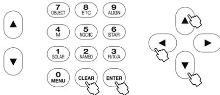
方向キー(▲)・(▼)で設定する等級を選択し、(ENTER) キーを押します。その後設定を完了する場合は(CLEAR)を押します。(または方向キー(◀)を2回押します。)
