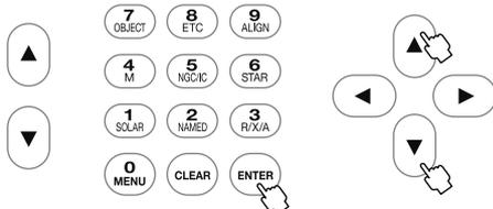
自動導入する場合は **ENTER** キーを押します。自動導入しない場合は方向キー **←** (または方向キー **▲**・**▼** で「キャンセル」を選択し、**ENTER**) で一つ前の画面に戻ります。
