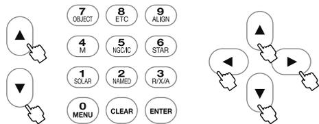
方向キー (▲・▼・◀・▶) を押すことで望遠鏡が動きますので、望遠鏡の視野中央に“アルデバラン”を導入していきます。ズームキーを用いると望遠鏡速度も変わります。画面表示を拡大すると速度が遅くなるため細かな修正ができるようになります。(P7参照)
