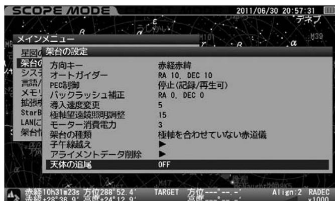
2 “天体の追尾”画面が表示されます。方向キー(▲)・(▼)でON/OFFを選択し、(ENTER)を押します。
