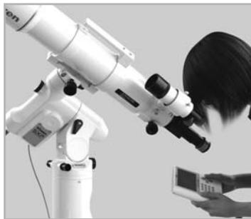
修正中、望遠鏡マークのところでPEC0(○には数字が入ります)と表示され、480から始まる数字(赤色)が1秒毎にカウントダウンされます(表示の都合で479からカウントダウンされます)。
