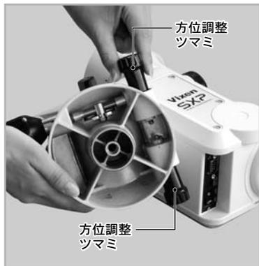
2 写真を参考に架台を三脚の上に置き、下から架台固定ボルト(下からのネジ)で固定します。取付ける際、三脚の架台部分にある水平支点(ツノ)が方位調整ツマミのネジではさみ込まれる位置になるように配置してください。(2-1)、(2-2)
