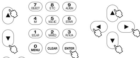
方向キー(▲・▼)で登録のない項目を選択し、(ENTER) (または方向キー(▶))を押して“新規作成”画面に進みます。方向キー(◀・▶)で設定値までカーソルを移動し、**ヒント43** 方向キー(▲・▼)または10キー(テンキー)にて文字または数値を入力します。すべて入力完了後(ENTER)を2回押して軌道要素データ入力完了です。
