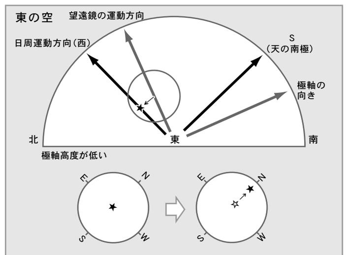
最終的に視野の中で星が南(視野の左下)・北(視野の右上)に移動しなくなった時点で高度調整の完了です。
