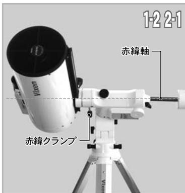
鏡筒を手でしっかりと支えながらアタッチメントレール(スライドバー)をしめつけている鏡筒固定ネジを少しゆるめます。Ⓢ注意
