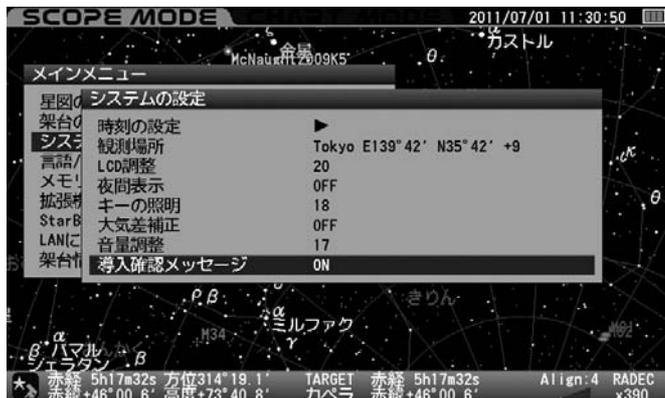
2 “導入確認メッセージ”画面が表示されます。方向キー(▲・▼) (またはズームキー(▲・▼))で ON/OFF を選択し、(ENTER) (または方向キー(▶))を押します。設定を完了する場合は、(CLEAR) (または方向キー(◀))を2回押します。
