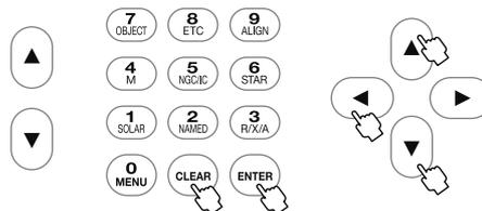
方向キー **▲**・**▼** で高度方位/赤経赤緯を選択し、**ENTER** を押します。
