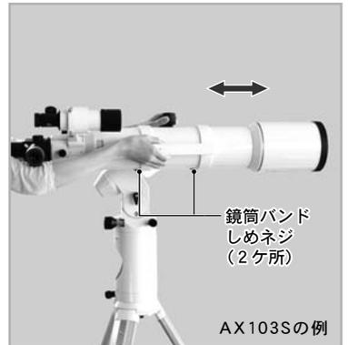
鏡筒を手でしっかりと支えながら鏡筒バンドのしめネジを少しゆるめます。Ⓢ注意
