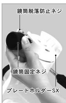
2 鏡筒のアタッチメントプレートWTを写真のようにプレートホルダーSXの溝にはめます。
