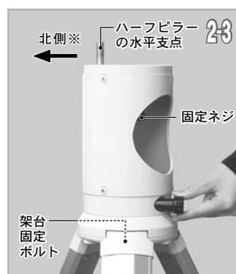
※ハーフピラーの水平支点が北側になるように三脚を設置してください。
