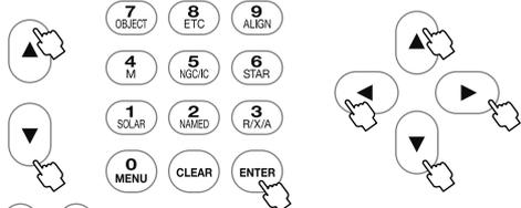
方向キー(▲・▼)で登録のない項目を選択して(ENTER) (または方向キー(▶))を押し、"新規作成"画面に進みます。方向キー(◀・▶)で設定値までカーソルを移動し、**ヒント42** 方向キー(▲・▼)または10キー(テンキー)にて文字または数値を入力します。すべて入力完了後(ENTER)を2回押して軌道要素データ入力完了です。
