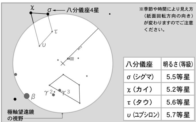
**6** 極軸望遠鏡を覗きながら極軸望遠鏡の鏡筒部(接眼レンズのあるところ)を回し、八分儀座4星の配置とスケールの図が平行になるまで回します。
