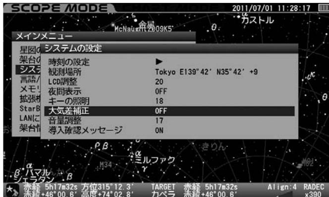
2 “大気差補正”画面が表示されます。方向キー(▲)・(▼) (またはズームキー(▲)・(▼))でON/OFFを選択し、(ENTER)を押します。
