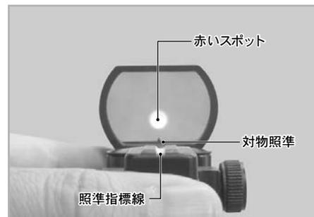
**3** XYスポットファインダーの明るさ調節ツマミを右に回して赤い点(スポット)を点灯させます。
