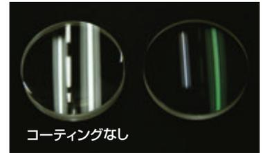
レンズのコーティングによる反射の違い。多層膜コーティングの方が、反射が少ないことがわかります。
