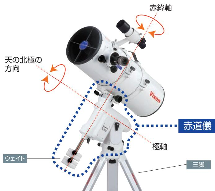
天の北極(北極星付近)を中心として回転する星の動きに合わせ、「赤道儀」は動く仕組みになっています。ビクセンの「赤道儀」は、モーターなどのパーツを組み合わせることで、天体の自動追尾や自動導入も可能です。※自動導入は一部の機種のみ対応(STAR BOOK TEN取付可能。右ページの「自動追尾・自動導入」の項目をご覧ください。)
