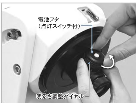
2 写真を参考に極軸望遠鏡を回してダイヤルが下向きになるようにすると古い電池が落下して取外せます。手でキャッチするなどして落とさないようにご注意ください。
