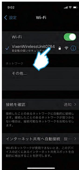
3 SSIDをタップするとパスワードを要求されますので、手動で入力します。工場出荷時のパスワードは「1234567890」に設定されています(SSID、パスワードはアプリ内で任意に変更できます)。
