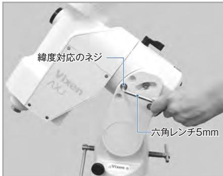
3 写真を参考に、赤道儀を手で支えながら赤道儀側面にある長穴のところのネジを付属の六角レンチ5mmで少しだけゆるめます（ネジは左右両面にあります）。ネジをゆるめると、赤道儀の自重により急激に落下することがありますので、手でしっかり支えつつ、様子を見ながらゆっくりと慎重に行ってください。
