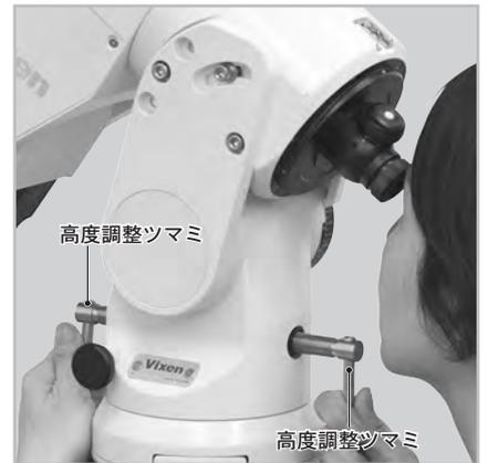
6 5で八分儀座 $\sigma$ 星( $\sigma$ Oct)を導入すると、 $\tau$ Oct、 $\chi$ Octの目盛付近にもそれぞれの星が近づきますので、極軸望遠鏡をのぞきながら、極軸望遠鏡(鏡筒部)を回して、スケール上にある $\tau$ Octおよび $\chi$ Octの所定位置に、それぞれ、八分儀座 $\tau$ 星、 $\chi$ 星が一番近くなるようにします。
