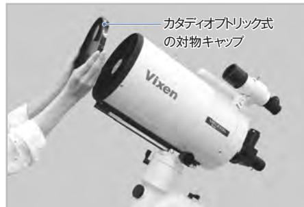
3 接眼レンズを取付ける場所(のぞく場所)を確認します。機種によって取付ける場所(のぞく場所)は異なります。**ヒント5** またフリップミラーの場合は接眼レンズを2ヶ所に取付けることができますので、のぞきやすい方の接眼レンズをのぞいてください。また、フリップミラーの切替ハンドルによって、のぞいている接眼レンズに光路が来るようにしてください。※まず、低倍率の接眼レンズから使ってみましょう。
