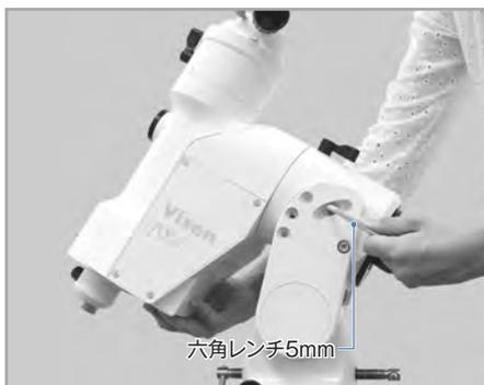
4 合わせたい緯度指標のネジ穴をのぞきながら赤道儀の高度を調整し、ネジ穴が揃うところで止めます。ここで、3でゆるめた長穴のネジを付属の六角レンチ5mmでしめて固定します（左右両側面）
