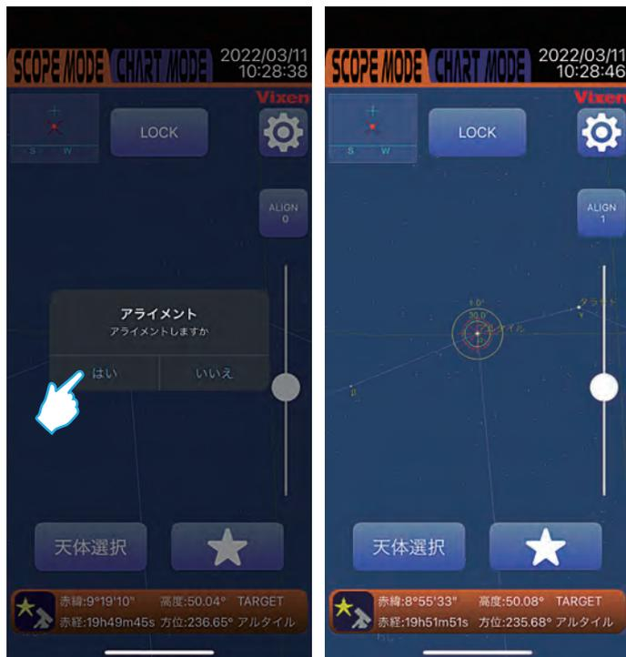
6 天体を正確に自動導入するには複数のアライメントが必要です。異なる恒星で工程2~5を繰り返し、2点目、3点目...とアライメントを追加することで自動導入の精度が向上します。3点以上のアライメントを取得することで実用的な自動導入精度が得られます。
