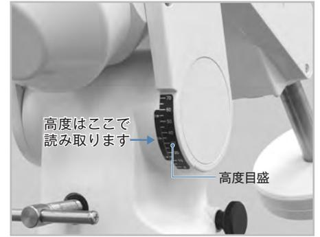
高度調整ツマミは片方をゆるめて、もう片方をしめながら動かします。方位調整ツマミも同様に動かします。
