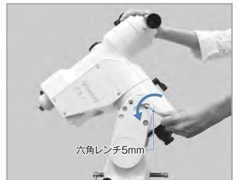
5 2で外したネジを4で合わせたネジ穴に通し、六角レンチ5mmでしめます（ワッシャーも忘れずに取付けてください）。ゆるまないようにしっかりと固定してください（左右両側面）。
