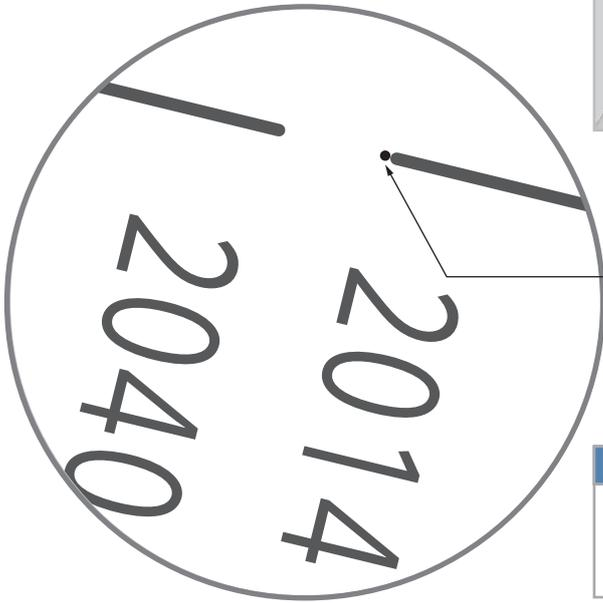
$\sigma$ Oct星を観測年にできるだけ近くなる位置に導入します。
