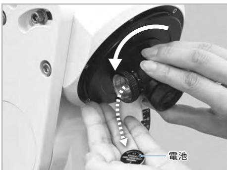
3 写真を参考に極軸望遠鏡を回してダイヤルが上向きとし、プラス・マイナス（+・-：極性）に注意して新しい電池（CR2032×1個）を落とし込みます。電池室の奥になるほう（下側）がプラス（+）となります。
