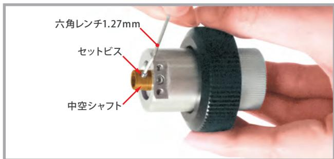
④写真を参考に、ピニオン軸の先端に中空シャフトを一番深く差し込みます。この時ピニオン軸の平らな部分とセットビスの位置が合うように差し込んでください。
