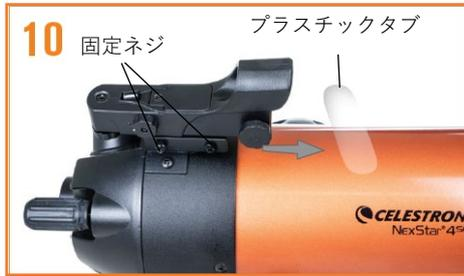
スターポインターファイダーの側面にある固定ネジを緩め、アリミゾ式ブラケットにスライドさせます。固定ネジを締めて固定します。電池カバーの下にある小さなプラスチックのタブを引き、電池が接触するようにします。(プラスチックタブの付いていない機種もあります)
