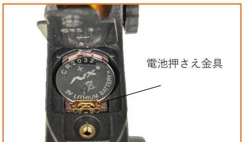
注意：電池押さえ金具をボタン電池で抑え込まないでください。必ず挟込んでください。
