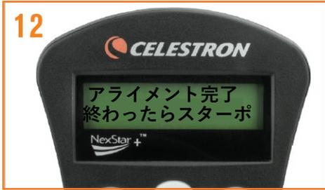
3つ目の明るい星についても、この手順を繰り返します。望遠鏡が3つ目の星にアライメントされると、ディスプレイには「アライメント完了」と表示されます。BACKボタンを押すとアライメントした3つの明るい星の名前が表示されず、ENTERを押してアライメントを終了します。スカイアライメントが失敗する時は、三脚が水平になっているかハンドコントローラーの入力で月/日/年の順番になっているか確認してください。また、3つの明るい星は、天頂付近の星は選ばない、地平線付近の星は選ばない、3つの星が直線にならない様に大きな三角形を描く星を選ぶ、月は面積が大きいのので選択しない、をご確認ください。
