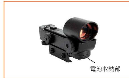
電池収納部がスターポインターファインダーのレンズ下部にあるタイプです。黒いプラスチックのフタは左右2ヶ所に切込みがありますので、爪などで切込み部分を引張ると取ることができます。
