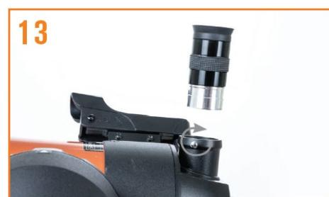
25mm接眼レンズのキャップを外し、25mm接眼レンズのスリーブをNexStar 5SEの天頂ミラー、またはNexStar 4SEの接眼ホルダーに差込みます。止めネジを締めて固定します。
