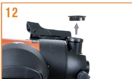
NexStar 4SEでは、望遠鏡の接眼部に天頂ミラーの機能が内蔵されています。接眼ホルダーからキャップを外します。
