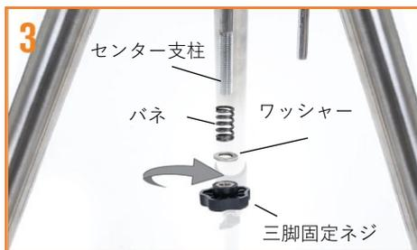
センター支柱の三脚固定ネジやパネ、ワッシャーを取外します。
