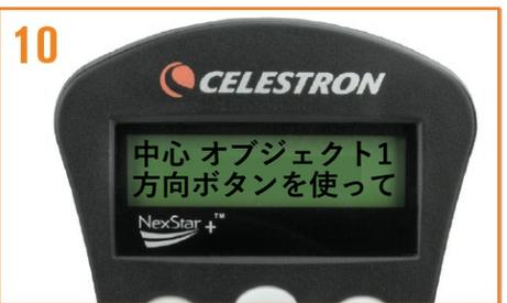
10 接眼レンズを覗くと、目標の明るい天体が接眼レンズの視野の中に見えます。見えない場合は、ハンドコントローラーの方向キーを押して視野の中に明るい天体を導入します。スピードが速く導入が難しい場合は、ハンドコントローラーのMOTOR SPEEDボタンを押し、数字キーの5や6を押します。明るい星が視野の中に導入できたらALIGNを押します。
