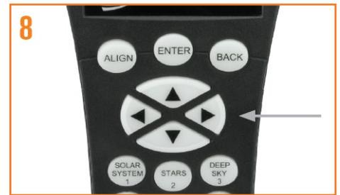
8 これでアライメントのためのハンドコントローラー入力が完了しました。ご自身の目で見て明るい天体の方向に、ハンドコントローラーの方向キーで望遠鏡を移動させます。
