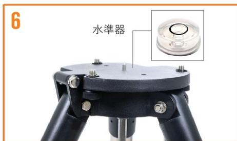
三脚が水平かどうかを確認するには、水準器を三脚の上に置いてください。必要に応じて各脚の高さを水準器を確認しながら調整し、水準器の泡が赤丸の中に入っているのを確認します。終わったら水準器を外してください。
