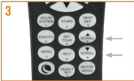
3 SCROLL UPおよびSCROLL DOWNボタン（それぞれ▲6および▼9キーが対応）を押して、「スカイライメント」を選択し、ENTERを押します。ハンドコントローラーが観測地の場所を尋ねてきます。
