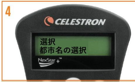
4 SCROLLボタン（▲6か▼9）で「選択 都市名の選択」を選択し、ENTERを押します。SCROLLボタン（▲6か▼9）で「Select Continent Asia」を選択し、選択したらENTERを押します。SCROLLボタン（▲6か▼9）で「国名の選択 Japan」を選択し、選択したらENTERを押します。観測地に一番近い都市をSCROLLボタン（▲6か▼9）で「Japan ○○○」を選択し、選択したらENTERを押します。
