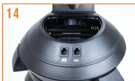
電池カバーの丸い部分を軽く持上げて、ドライブベース中央から電池カバーを外します。単3形乾電池8本を電池ホルダーにセットし電池カバーを再び取付けます。電池の極性に注意して挿入してください。注：冬場の乾電池での観測はすぐに電池切れを起こします。別売のPower Tank Lithiumなどの外部バッテリーをご使用ください。
