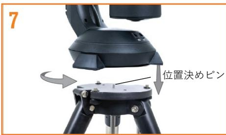
ドライブベース中央の穴が三脚上部の位置決めピンに合うように、望遠鏡のドライブベースを三脚のヘッドに載せます。望遠鏡の架台を回転させ、カチンと音がするまで3つのゴム足が三脚の取付けプレートから突き出た3つの取付けネジと一致するようにします。
