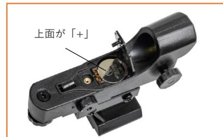
電池が取り出しにくい場合は、マイナスドライバーや先の細い物で取出してください。新しいCR2032電池をプラス側が上に見えるように挿入します。電池フタを閉めてプラスネジを締めます。
