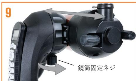
バランスを調整したり、架台フォークアームから鏡筒を外すには、鏡筒固定ネジを緩めて、鏡筒を接眼部方向にスライドさせます。鏡筒の取付け、取り外しの際は、鏡筒をしっかりと持ってください。鏡筒を外す前に、プレートホルダーの鏡筒固定ネジが締まっていることを確認してください。
