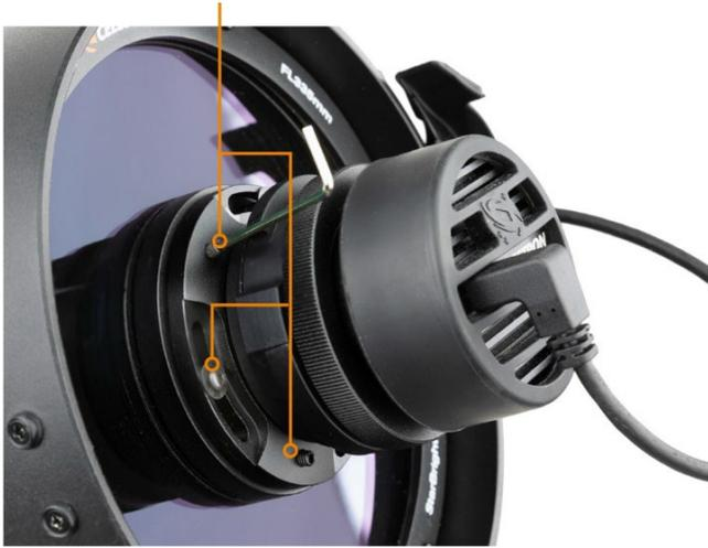
図34：光軸調整ネジでレンズ群（およびカメラ）の傾きを調整します。
