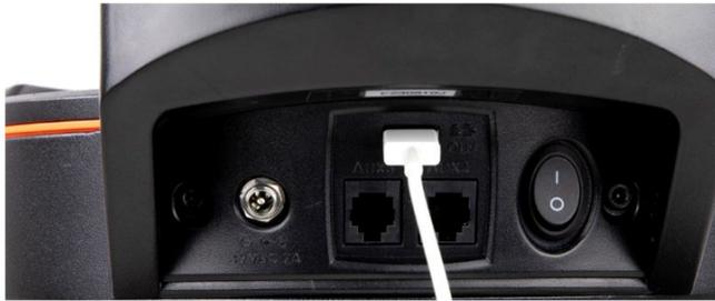
図38：Origin Intelligent Home Observatory 架台のUSB充電ポートを使って、観測地でデバイスを充電することができます。
