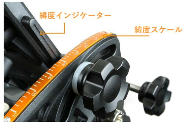
図D2：ウェッジの緯度調整ノブを、緯度インジケーターが目盛りの現在地の緯度に合うまで回します。
