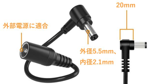
図D5：赤道儀ウェッジモードで外部電源を使う場合、電源プラグがOrigin Intelligent Home Observatoryのベースとウェッジの間に挟まらないように、Origin Intelligent Home Observatoryの電源ジャック用の直角アダプターの購入を検討してください。この現象は、緯度35度以上でよく起こります。アダプターの高さは20mm以下で、アダプターのプラグは外径5.5mm/内径2.1mmのDCプラグです。
