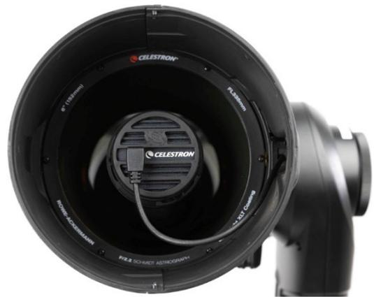
図29：工場撮影され、Origin Intelligent Home Observatoryにプリロードされたフラットフレームは、カメラが図の向きで撮影されたものです。この向きからカメラを回転させると、新しいフラットフレームを作成する必要があります。
