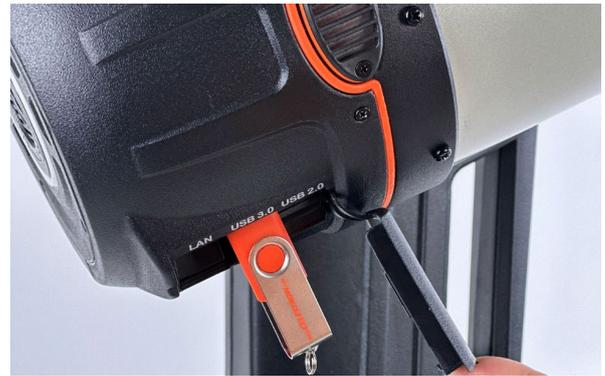
図27：Origin Intelligent Home Observatory鏡筒のUSBポートにUSBメモリを挿入し、RAW画像ファイルを転送します。
