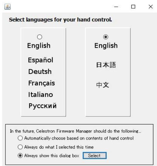
⑨メニューの「NexStar+」をクリックし、Mount Typesを選択します。経緯台の場合はNEXを、赤道儀の場合はGEMの裂を選択します。Always show this dialog boxにチェックマークを付けます。Selectをクリックします。
