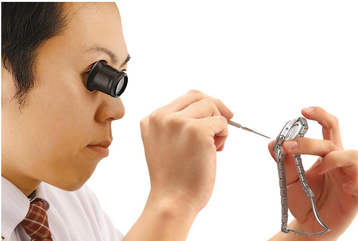
ルーペの位置や角度を調整する必要がなく、両手を使った作業がはかどります。倍率は5倍と高倍率のため、時計修理などの精密作業に適しています。
