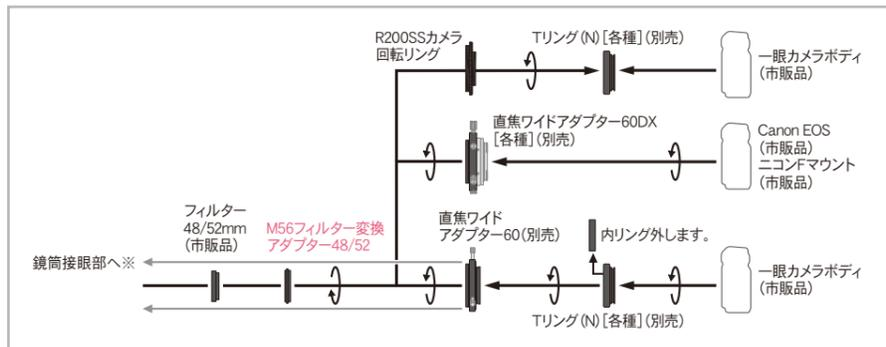
直焦ワイドアダプター60DX(別売)、直焦ワイドアダプター60(別売)、60→50.8AD(別売)併用にてA81M、A105MII、SD81S、SD103S、SD115S、AX103S、FL55SS、VC200L、VMC260L、R200SS 鏡筒に取付けできます。
