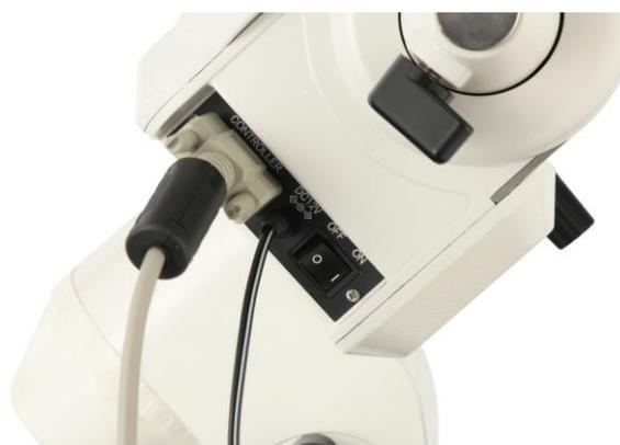
本製品は、セレストロン社製ポータブル電源「PowerTank Lithium（パワータンクリチウム）」をビクセン赤道儀に使用するために必要なプラグ変換コードです。DC12V EIAJ RC5320A class4（センタープラス）仕様の電源に対応するビクセン赤道儀（SX、AXJ、AXD シリーズ）にてご使用いただけます。
