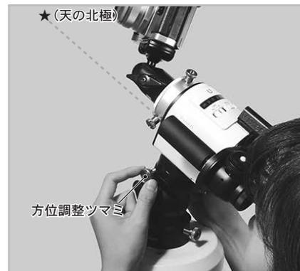
「POLARIS」表記の近くにある、2014、2040 に挟まれた線分の切れ目に、北極星を導入してください。(図参照)
