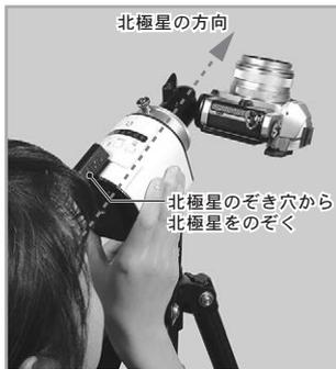
**4** 素通しファインダーから北極星が見えるかどうか確認し、北極星が中心に見えるように調整します。北極星のぞき穴から北極星が中心に見えていない場合は、ポラリエU本体を手で支えながら三脚の向きを調整し、中心に見えるようにします。調整後は三脚をしっかりと固定してください。
