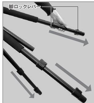
三脚は転倒しないように完全に開いた状態で設置してください。
