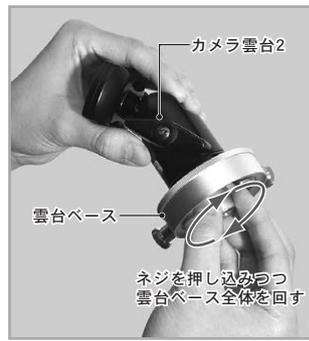
**5** 雲台ベースを元に戻します。2本のネジでゆるまないようにしっかり固定してください。コインや付属の六角レンチで増し締めすることもできます。
