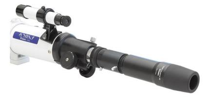
焦点距離100mm (※1) と倍率を低く設定できる簡易接眼レンズなので、目標物を非常に捉えやすくなっています。内部には十字線を装備し、十字線の中心に目標物を捉えたら、あとは観察用の接眼レンズと差し替えとピントを合わせれば観測ができます。
