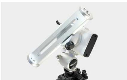
雲台などを介してカメラを搭載するプレートです。端面には「クイックリリースパノラマクランプ」（別売）または市販のカメラ雲台（1/4 インチ）を装着可能です。プレート自体をスライドさせて回転軸まわりのバランスを合わせれば、より安定した追尾が可能となります。フルサイズ一眼レフカメラ+大型望遠レンズのような、重量のある機材でも「APフォトガイダー用ウエイト軸」（別売）、「バランスウエイトWT1kg」（別売）などを併用して、バランスを合わせることができます。
