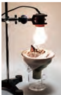
ツルグレン装置 白熱灯の準備が難しい時は、 上の画像のようにカイロを乗 せてもOK。
